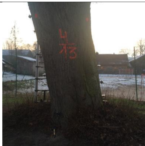
Fot. 5-3. Lipa nr 4/13 podstawa pnia z zamontowanymi czujnikami
